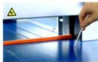
8fach verwendbare, leicht zu wechselnde Schneideleiste
